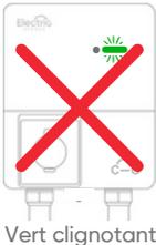
Lors du lancement d'une charge, si le voyant d'état DEL (barre) ne passe pas du vert fixe (indiquant le lancement d'une charge : communication avec le véhicule) au vert clignotant (indiquant la charge en cours), débranchez le connecteur du véhicule et redémarrez le session. Si des tarifs injustifiés résultent de cet échec, veuillez contacter Electric Avenue pour obtenir une compensation.
