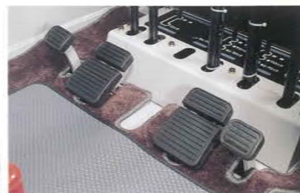
油圧アシストブレーキを装備し、オペレータの疲労を軽減。
