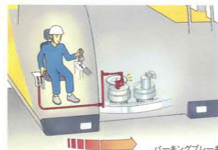
傾斜地での旋回を容易にする 旋回サーブスブレーキを設定。
