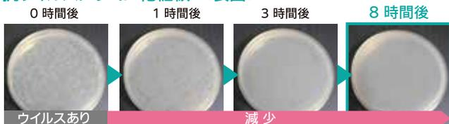
※上記の写真は社内実験室でJIS R1756の試験方法を参考に行った場合の試験結果です。
