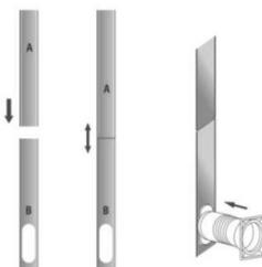
**ÉTAPE 4 :** Ouvrez la fenêtre et placez la trousse de fenêtre sur le bord intérieur de la fenêtre. Ajustez la plaque d'étanchéité de la fenêtre à la largeur de la fenêtre. Une fois qu'elle est bien fixée, fermez la fenêtre pour la verrouiller en place.
