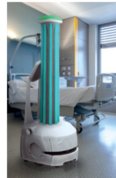
Le robot XuP-Steri est équipé de lampes UV-C pour la désinfection des lieux publics.
