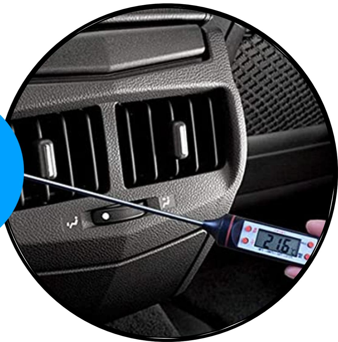
La température doit chuter de 10 degrés environ par rapport à la température interne du véhicule.
