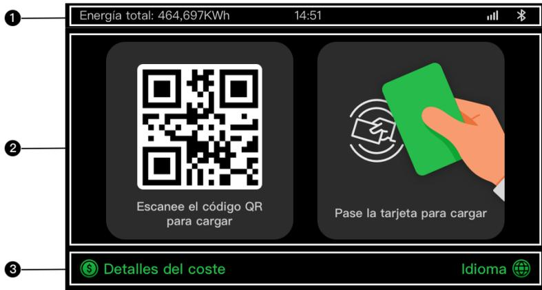
1. Pantalla superior - muestra la energía total suministrada, el tiempo, la intensidad de la señal y la conexión Bluetooth
