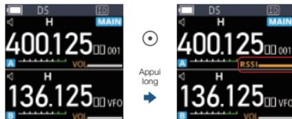
Sélection de la bande de fonctionnement Sélectionnez la bande de fonctionnement en mode VFO, comme illustré ci-dessous.
