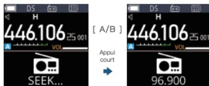
3. En mode radio, vous pouvez enregistrer la fréquence actuelle en appuyant brièvement sur la touche [Menu]. Appuyez longuement pour basculer entre le mode fréquence et le mode canal.
