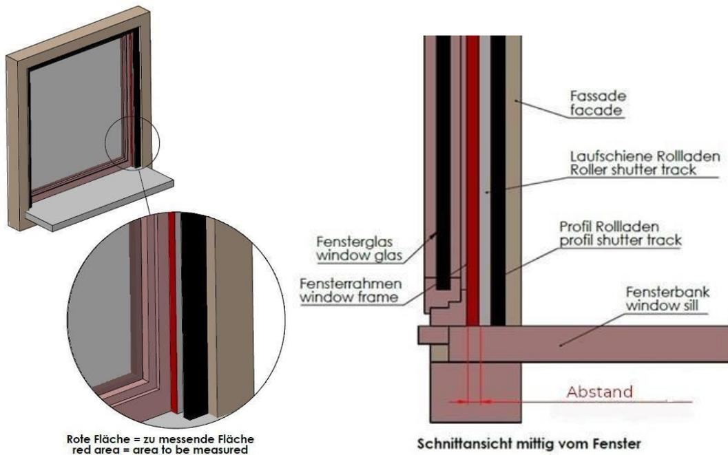
2. Breite ausmessen. Messen Sie die Breite **vom äußersten Punkt der linken Kante bis zum äußersten Punkt der rechten Kante des Fensterrahmens**, wie in der folgenden Abbildung zu sehen.
