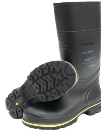
Stivale di sicurezza resistente al calore in conformità allo standard EN 15090 HI3 F3A per la resistenza alla fiamma, il calore radiante (20 kW/m<sup>2</sup>) e l'isolamento termico della suola (250°C per 40 minuti). Questi stivali sono progettati per l'uso in zone dove c'è rischio di scintille da saldatura o molatura o per l'estinzione di incendi nelle immediate vicinanze.
