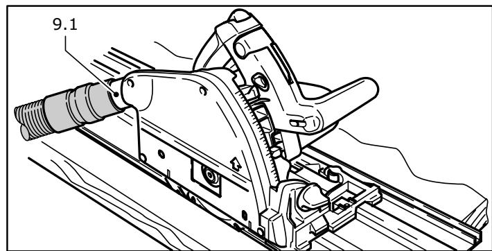
En los racores móviles de aspiración (9.1) puede acoplarse un aspirador Festool con un diámetro del tubo flexible de 36 ó 27 mm (se recomienda 36 mm debido al mínimo peligro de atascamiento).
