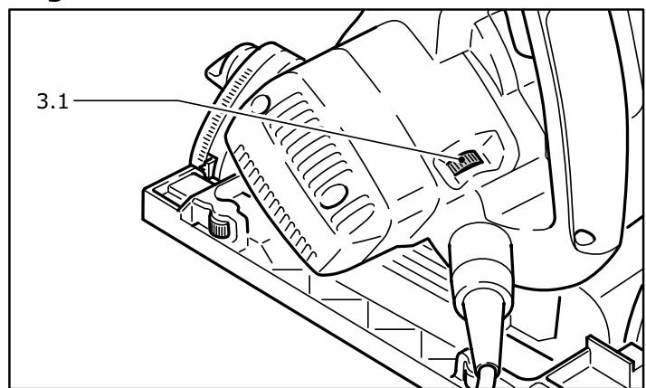
Con ayuda del regulador del número de revoluciones (3.1) se puede ajustar la velocidad de la hoja de sierra, sin escalonamientos, a un valor de entre 1350 y 3550 rpm. De esta forma, la velocidad de corte se puede adaptar de forma óptima a cada material.
