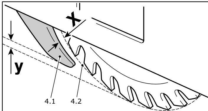
**ADVERTENCIA** La TS 75 EQ está equipada de serie con una cuña de incisión (4.1). ¡Por razones de seguridad, todos los trabajos de aserrado sólo deben ser llevados a cabo estando montada y correctamente ajustada la cuña abridora!
