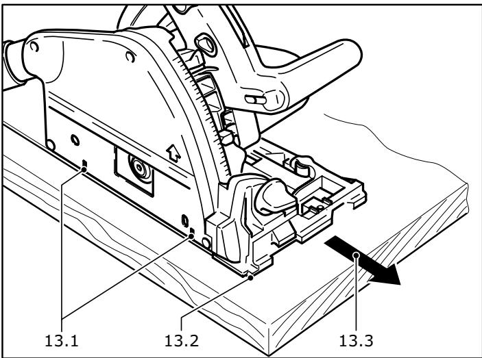
**AVERTISSEMENT** Sciez uniquement en sens opposé (poussez la scie circulaire vers l'avant, 13.3), jamais dans le même sens (en tirant la scie en arrière). Le sciage dans le même sens risque de faire sortir la scie de la fente de coupe (contre-coup) et peut provoquer de graves blessures.
