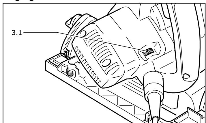
Le régulateur de vitesse (3.1) permet de régler progressivement la vitesse de la lame de scie entre 1350 et 3550 tr/min. Vous pouvez ainsi adapter de façon optimale la vitesse de coupe à chaque matériau.
