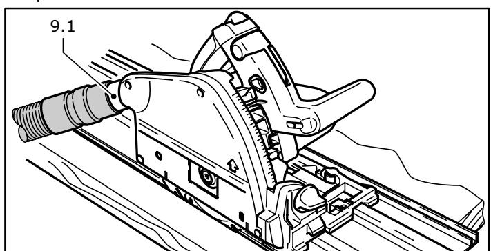
Il est possible de raccorder un aspirateur Festool d'un diamètre de tuyau d'aspiration de 36 mm ou 27 mm (recommandation: 36 mm à cause du risque de bourrage moins élevé) aux raccords d'aspiration rotatifs (9.1).
