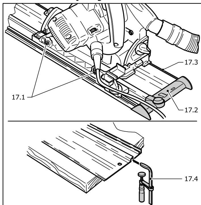
La possibilité de fixation au moyen de serre-joints (17.4) garantit un maintien fixe et un travail en toute sécurité. Le déflecteur (optionnel) (17.2) empêche tout coincement du fil ou du tuyau en bout de rail de guidage.
