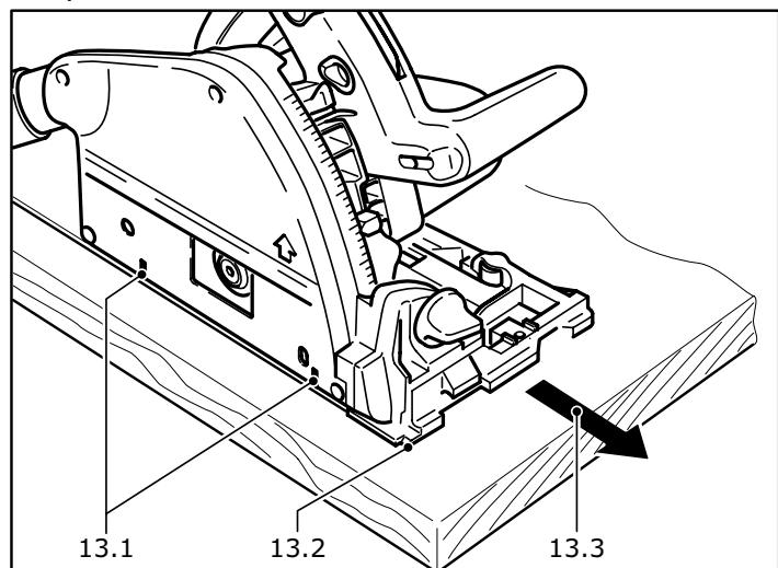
**ADVERTENCIA** Corte siempre en el sentido contrario al del avance de la pieza, es decir, contra la pieza (desplazando la sierra circular de mano hacia delante, 13.3) y nunca en el sentido del avance de la pieza, es decir, apartándose de la pieza (desplazando la sierra circular de mano hacia atrás). Al aserrar en el sentido del avance de la pieza existe el peligro, de que la sierra circular de mano salte fuera de la ranura de corte (rebote), pudiendo producir lesiones graves.
