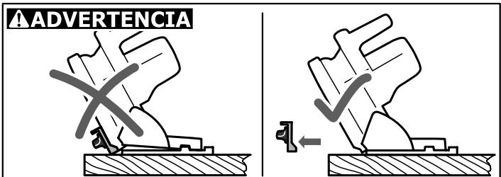
**Utilice la protección contra astillas sólo para cortes de 0°. Retire siempre la protección contra astillas al realizar cortes a inglete.** La protección contra astillas provoca que la sierra circular se desvíe al realizar cortes a inglete en la pieza de trabajo, por lo que pueden producirse lesiones graves.
