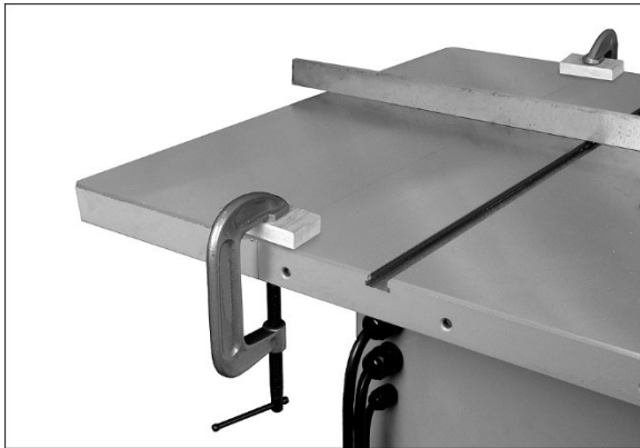
Figura 6-5: nivelación de las alas de extensión, método 2
