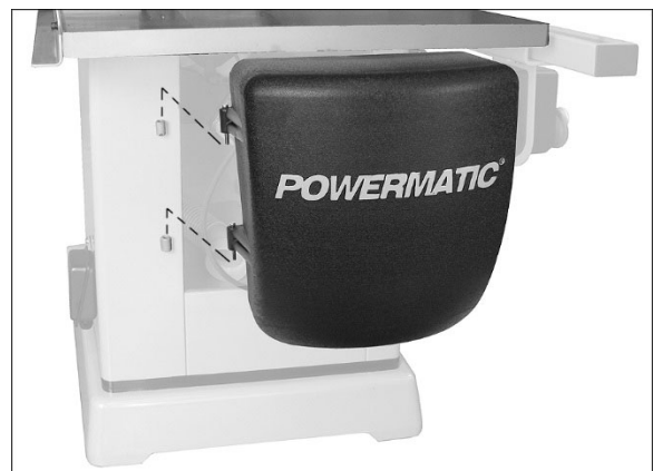
Figura 6-7: instalación de la cubierta del motor
