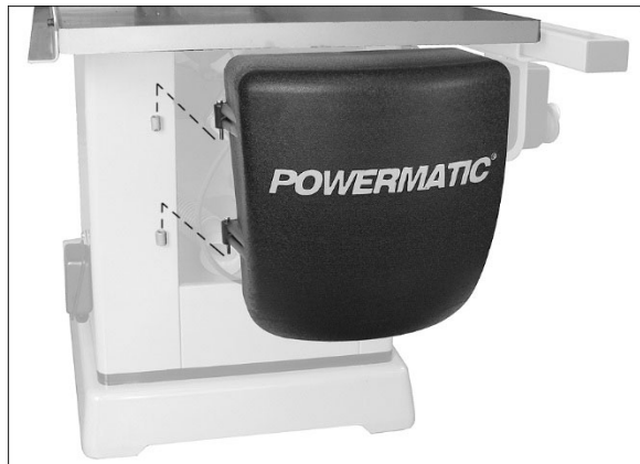
Figure 6-7 : Installer le couvercle du moteur
