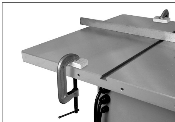
Figure 6-5 : mettre à niveau les rallonges, méthode 2
