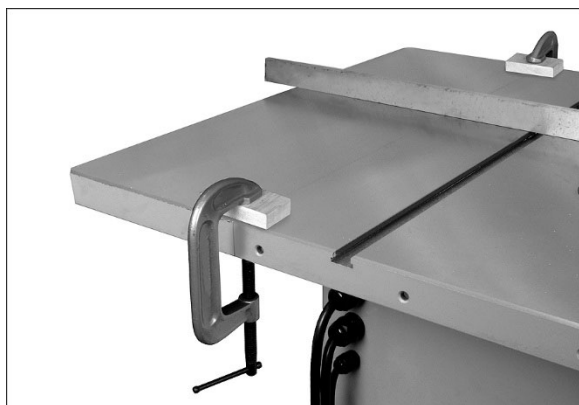
Figure 6-5 : mettre à niveau les rallonges, méthode 2
