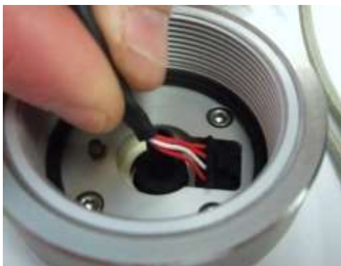
Figura 35: cable de la entrada calefactada
