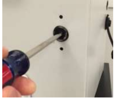
Figura 1: Abra el armario con un destornillador de cabeza plana girando un \frac{1}{4} de vuelta
