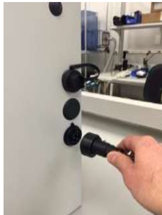
Figura 20: Conexión de alimentación DustTrak ( izq ). Conexión AC final a la Fuente de alimentación exterior (Fuente de alimentación DC usará conector de 2-pin en el lado izquierdo del armario – dcha )
