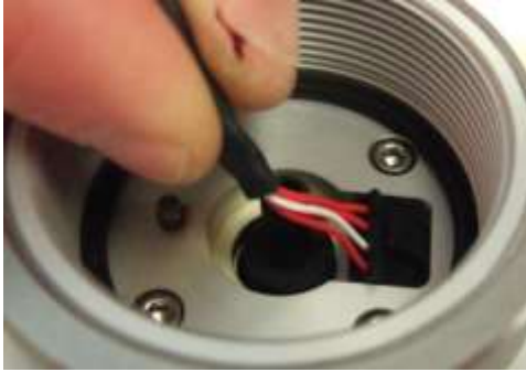
Figura 27: Retire el conjunto de entrada calefactada
