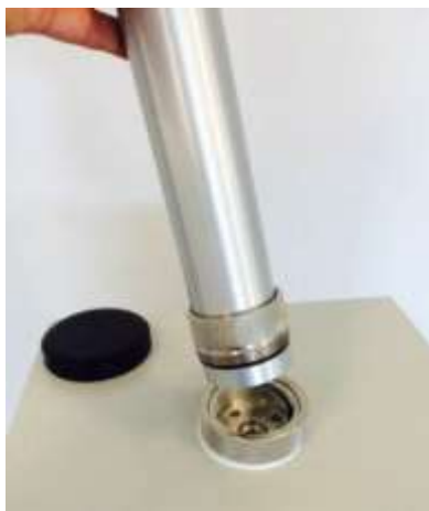
Figure 36: Alineando el módulo de entrada
