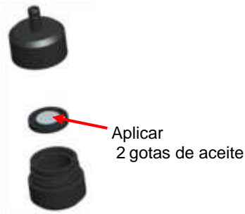
Figura 39: Aplicar dos gotas de aceite en la placa de impacto
