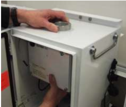
Figure 30: Retire el fotómetro del armario
