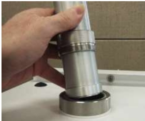
Figura 26: Tire de la entrada calefactada hacia arriba
