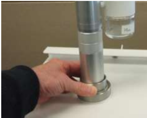
Figura 22: 9. 1. Desenrosque el segundo anillo estriado de la parte inferior
