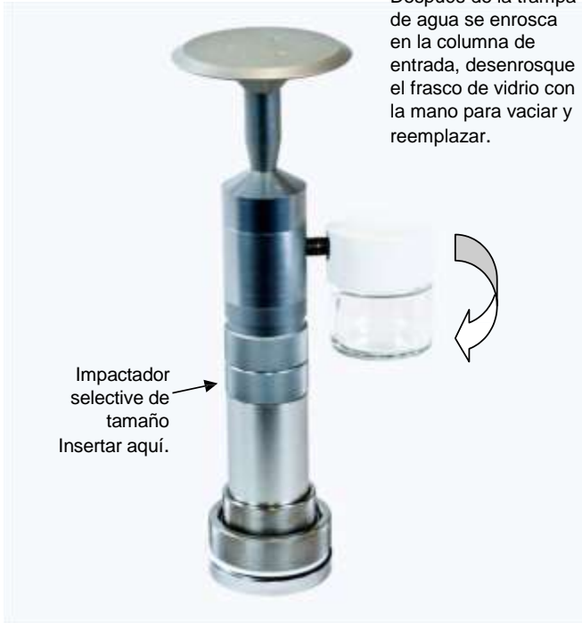
Figura 18: Eliminación del frasco de vidrio del flujo de la chimenea
