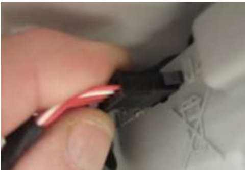
Figure 24: Desconecte el cable de la entrada calefactada
