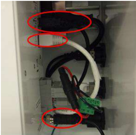
Figure 28: Retire los cables USB, Ethernet, y alimentación.
