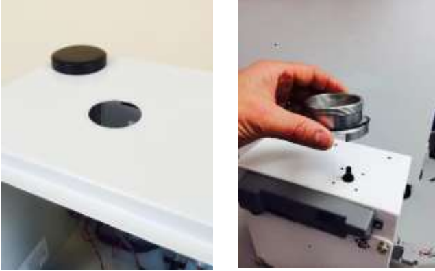
Figure 33: Retire el anillo de montaje del fotómetro
