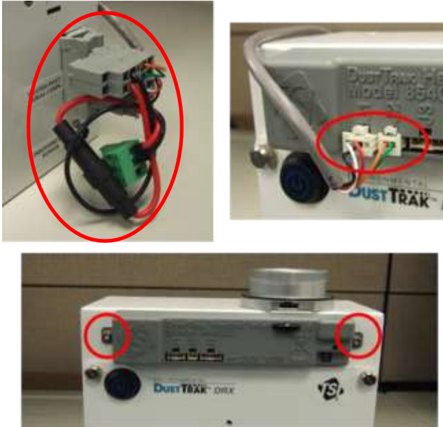
Figura 31: Retire los cables y el controlador de la entrada calefactada
