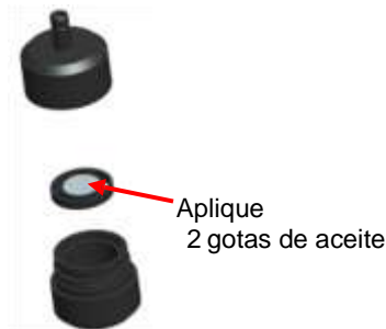
Figure 19: Aplique dos gotas de aceite a la placa del Impactador
