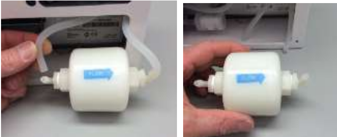
Figura 21: Desconecte y retire el filtro de aire viejo del instrumento
