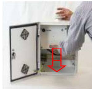
Figura 25: (a) cable entrada calefactada; (b) Quitar el anillo de retención y el fotómetro del inferior
