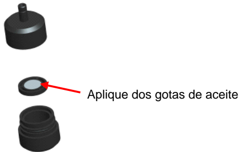
Figura 4-4: Aplicar 2 Gotas de Aceite a la Placa del Impactador
