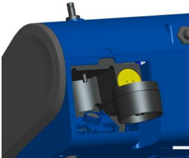
Figura 4-8: Retire el Filtro Casete de 37 mm
