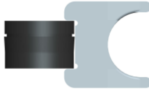
Figura 4-20: Reemplace las mallas en el soporte del filtro
