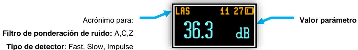
Figura 0-11 Pantalla modo visualización Running SPL
