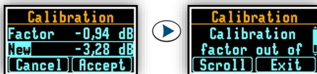
Figura 0-35 Aviso de factor de calibración fuera de rango
