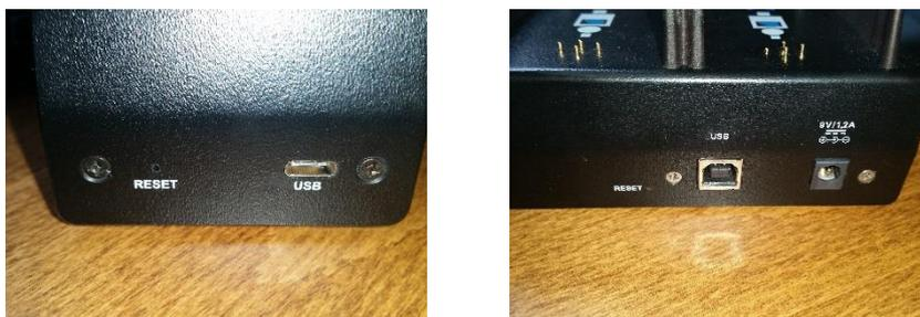
Figura 0-43 Conexiones USB de las Estaciones de Carga
