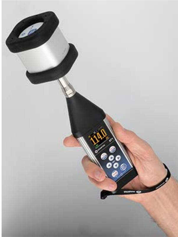
Figura 2. Calibración del Sonómetro SVAN 971 con micrófono de ½”
