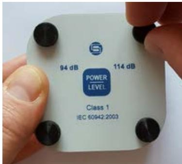
b) Sujete la tapa y desatornille con los dedos los 4 tornillos de fijación
