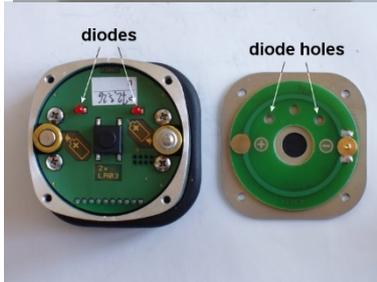
e) Introduzca la pilas nuevas en sustitución de las pilas descargadas, respetando la polarización indicada en la placa y carcasa del calibrador
