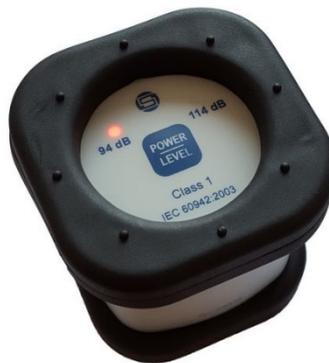
**Figura 4. Vista superior del calibrador SV 36 con un indicador luminoso encendido**
