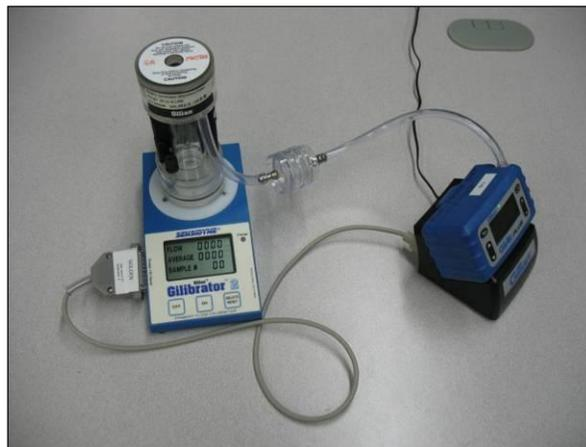
1. Conecte el cable SmartCal al conector serie PC del Gilibrator y el Puerto del Dispositivo de Referencia en la parte de atrás del la Estación.
