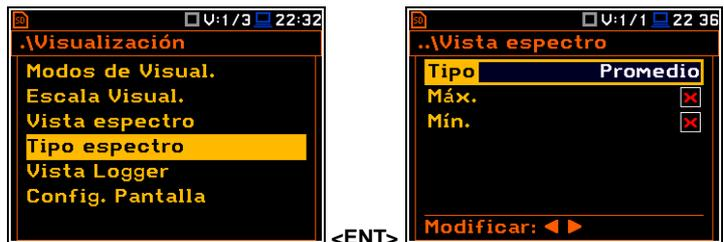
Quando el espectro **Promedio** o **Instantáneo** se selecciona, el usuario además puede activar o desactivar los valores de la presentación **Max** o **Min** para cada banda del espectro mostrada se coloca o se reponer el carácter especial de la línea que se muestra inversamente el texto con **Max** o **Min** por medio de los botones **<3>**, **<4>**
