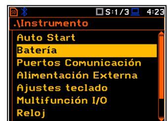
El punto de vista presentado en la pantalla para cada uno de los tres tipos de posibles fuentes de energía es diferente. El voltaje actual de la batería se muestra junto con su estado aproximado (en formato gráfico).
