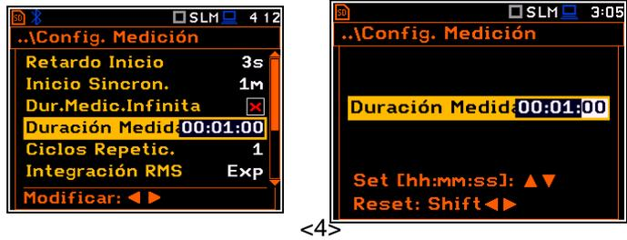
La medición se detiene automáticamente después de este tiempo, o la medición se iniciará de nuevo cuando se selecciona la **Ciclos Repetic.** y es mayor que uno. Las definiciones de los resultados de las mediciones en que se utiliza el tiempo de integración se da en la aplicación D. (App. D.)
