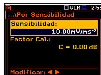
Para una sensibilidad del acelerómetro inferior a 10,0 mV / ms<sup>-2</sup> el factor de calibración será siempre positivo. El valor más bajo posible de la sensibilidad que se puede introducir es igual a 10,0 mV / ms<sup>-2</sup> (se ajusta al factor de calibración igual a 60,0 dB) y el valor más alto es igual a 10,0 V / ms<sup>-2</sup> (el factor de calibración es igual a - 60,0 dB).
