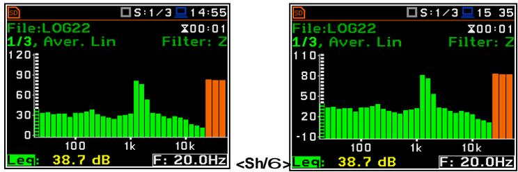
El usuario puede cambiar la opción del cursor por medio de los botones <3>, <4>. La frecuencia y el valor adecuado se presentan en la línea debajo de la gráfica. El usuario puede cambiar rápidamente la primera o última línea del espectro pulsando simultáneamente los botones <3> o <4> con el <Shift>.
