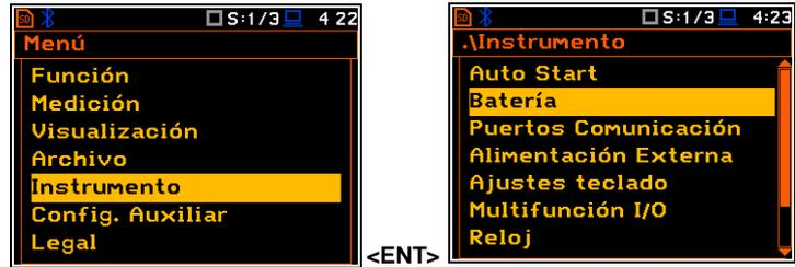
La lista del **Instrumento** se utiliza para ajustar los distintos parámetros que se dedican principalmente al control del hardware del equipo y contiene los siguientes elementos:
