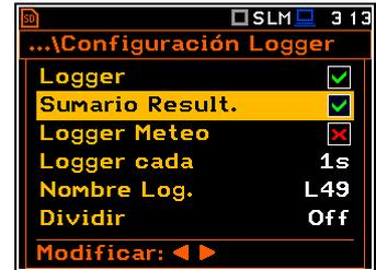
El **Registro Meteo** habilita los interruptores (0) y desactivación (☒) del registro de los resultados meteorológicos de la estación de tiempo de monitoreo.
