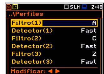
**Configuración de perfiles predeterminados para las mediciones de Vibración:**
