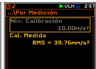
Se recomienda repetir la medición de calibración un par de veces para asegurar la integridad de la calibración. Los resultados obtenidos deben ser casi idénticos (con  $\pm 0.1$  dB de diferencia). Algunos motivos posibles para los resultados inestables son los siguientes:
