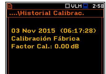
Si no se realizaron las medidas de calibración, la ventana **Última Calibración** no contiene ningún registro de calibración anterior. El contenido de esta ventana se borra después de la operación **Ajustes Fábrica**.
