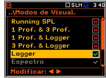
Cuando el **Registro** está activado y hay resultados seleccionados para el registro en la pantalla del perfil en la función de visualización es como se indica aquí.
