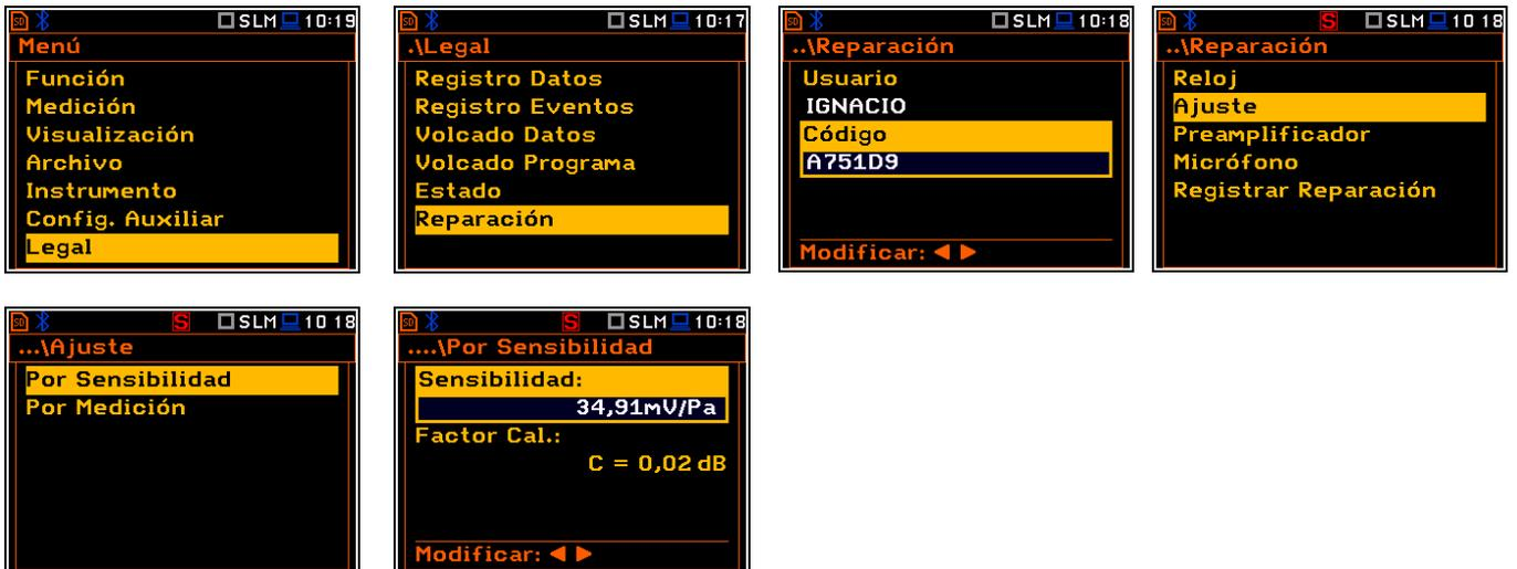
El procedimiento para realizar el ajuste de sensibilidad del micrófono por medición es el siguiente:
