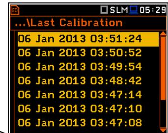
Para revisar los registros de calibración, el usuario tiene que seleccionar la línea deseada en la ventana **Última Calibración** y pulsar <ENTER>. La ventana abierta contiene la fecha y hora de la medición de calibración realizada, la forma en que la calibración se llevó a cabo (**Calibr. por Medición** o **Calibr. por Sensibilidad**), y el nivel de calibración deseada (Cal. Level) en el caso de las mediciones y el factor de la calibración obtenida (**Factor Cal.**).
