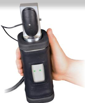
En la verificación in-situ se requiere el uso de un calibrador de vibraciones SV110 designado para la comprobación y ajuste básico del instrumento. Durante el Procedimiento de verificación y ajuste, el acelerómetro SV107 se instala en el soporte del calibrador con el adaptador de calibración el SA105A el cual produce un nivel de vibración de  $10 m/s^2$  a 80 Hz. El proceso de verificación tiene una duración de 30 segundos para cada uno de los ejes.
