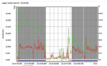
La ISO 5349-2 menciona que la medición de la fuerza de contacto se debe utilizar para detectar cuando las manos del trabajador hacen el primer contacto con la superficie de vibración y también cuando el contacto se interrumpa. Con el desarrollo de la SV103, se hizo posible obtener automáticamente información sobre el período que la mano está en contacto con la superficie de vibración para evaluar el tiempo de contacto total por día.
