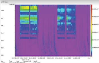
La ISO 5349-1 indica se puede informar no ponderadamente en la banda de un tercio de octava las magnitudes de aceleración RMS sobre el rango de frecuencia del sistema de medición. Una característica de las vibraciones mecánicas es el espectro de frecuencias es el que se muestra en los espectrogramas. Con esta potente solución es posible verificar si la fuente de vibración registrada fue producida por una máquina.
