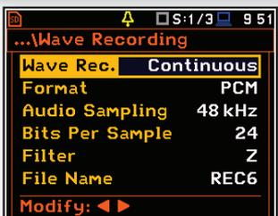
El registro de Audio es una función muy útil para la identificación de fuentes sonoras, permitiendo conocer la procedencia del ruido. El registro de la señal se puede realizar con una resolución de hasta 48 kHz. Hay 2 métodos disponibles para el registro de audio, eventos embebidos en el registro de evolución temporal o registro de la señal en formato wave para posterior posprocesado con el software SvanPC++ o cualquier otros programa.
