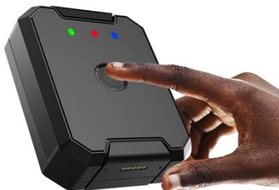
2. Después de encender, espere a que el LED verde parpadee lentamente (encendido durante 1 segundo, apagado durante 3 segundos), lo que indica que el dispositivo se ha conectado correctamente a la red.
