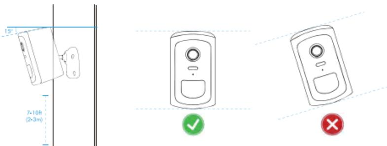
1. La caméra doit être placée à une hauteur de 2 à 3 mètres du sol.
