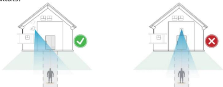
4. Il n'est pas conseillé d'installer la caméra verticalement en direction d'objets en mouvement, sinon elle risque de ne pas détecter les mouvements ou d'entraîner des retards.
