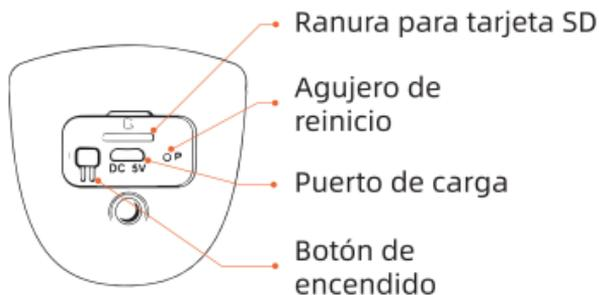
Botón de encendido: Pulse durante 5 segundos para encender/apagar la cámara.
