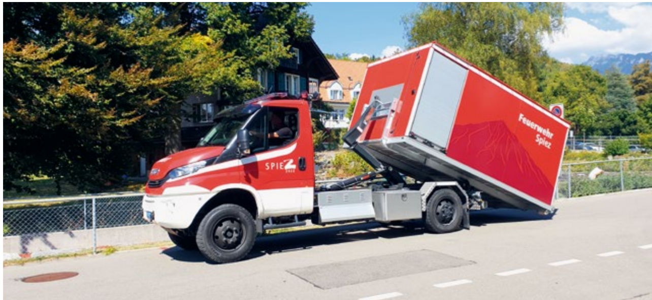
Das neue Materialtransportfahrzeug der Feuerwehr Spiez mit dem Standard-Modul, dem Logistikmodul. Darin können Rollcontainer zum Einsatzort geführt und über eine Rampe rasch ausgeladen werden.
