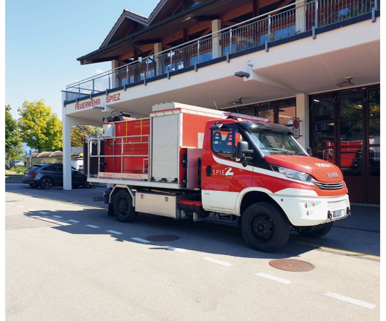
Mit dem Schlauchverleger kann der Wassertransport über weite Strecken in nützlicher Frist sichergestellt werden, da bis zu 2000 Meter Schlauch rasch verlegt werden können. Dank neuester Technologie kann der Schlauch während der Fahrt gleich wieder gereinigt und aufgenommen werden.
