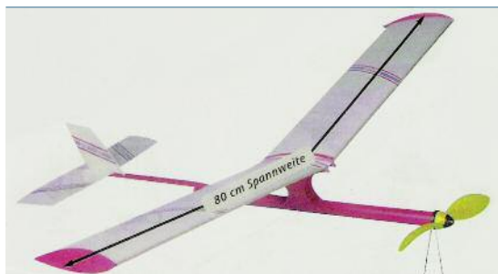
«Libelle»: Spannweite 80cm, Länge: 65cm, Gewicht 80g
