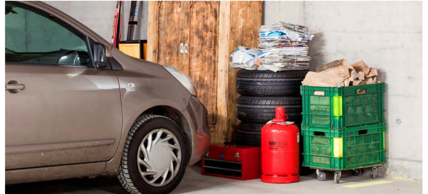
Schlechtes Beispiel einer Einstellhalle: versperrte Fluchtwege, gelagerte Materialien, welche die Brandgefahr erhöhen.
