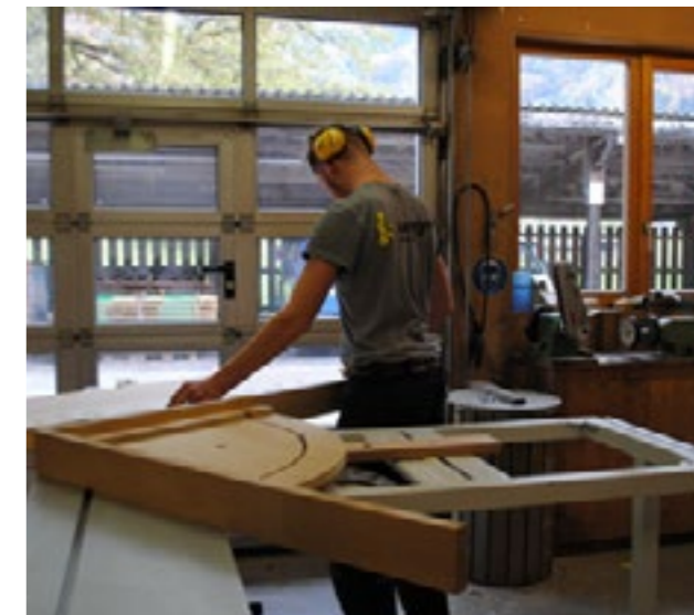
Philipp Lutz bearbeitet die neuen Teile des Mühlrads auf der Tischkreissäge.
