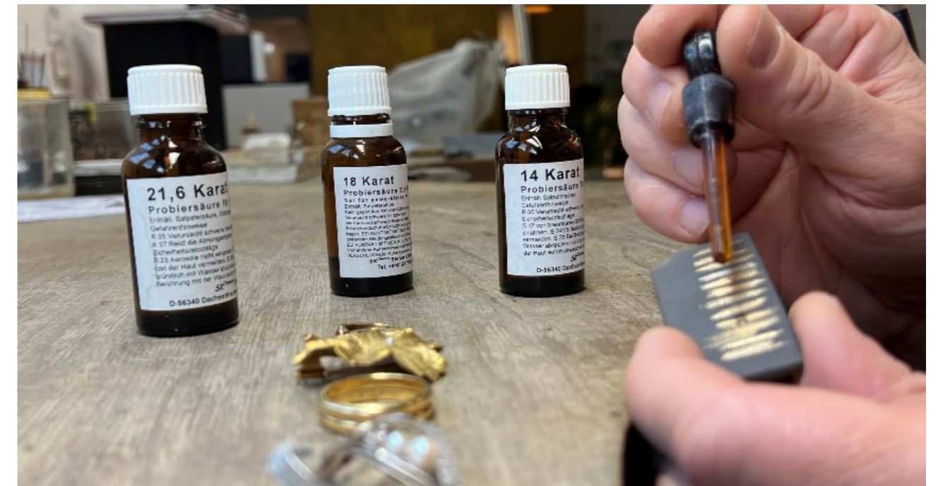
Erhaltenes Altgold wird mit Prüfsäuren genau geprüft. Das Edelmetall wird dann auf 0.1g genau gewogen und, falls gewünscht, bar vergütet.
