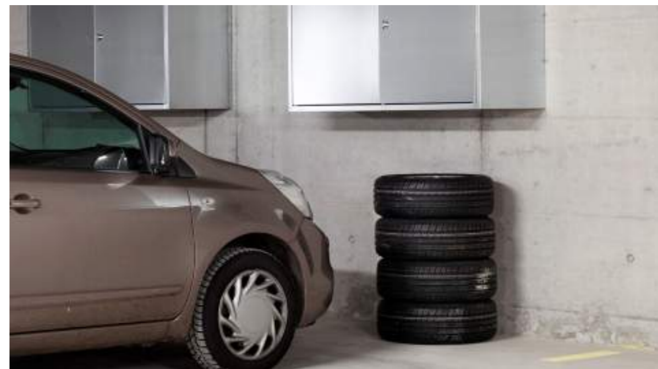
Gutes Beispiel einer Einstellhalle: freie Fluchtwege, keine brandgefährlichen Materiallager. Foto: Beratungsstelle für Brandverhütung BFB
