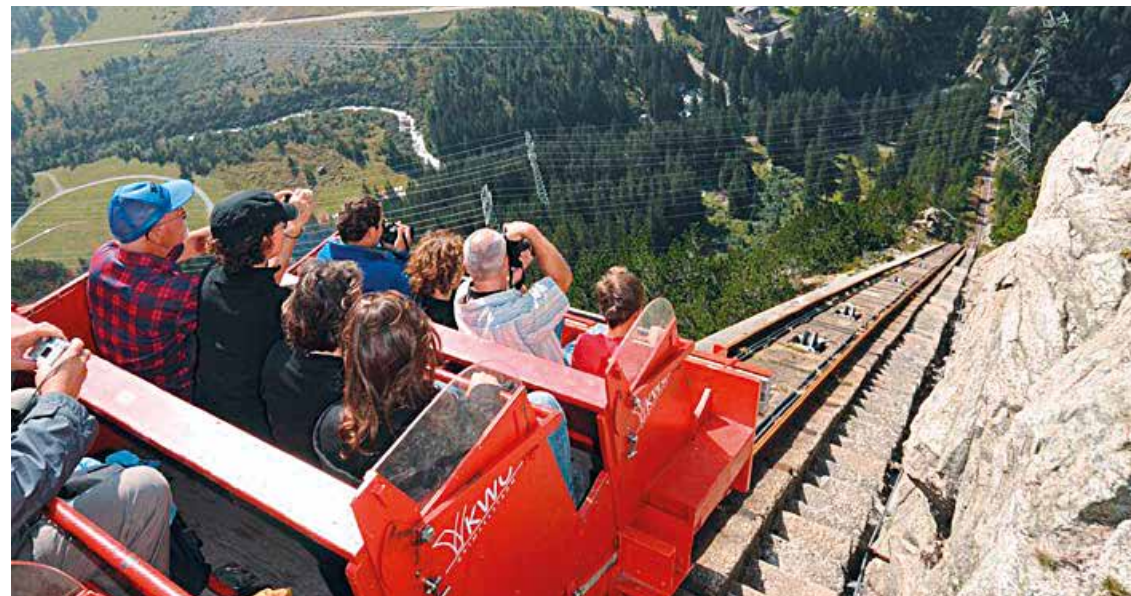
Wer den Nervenkitzel sucht, findet ihn auf der Gelmerbahn. Eine Steigung von maximal 106 Prozent macht sie zur steilsten Standseilbahn Europas. (Bild zvg)
