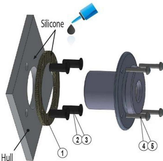
**2461 isoleringssats innehåller:**
