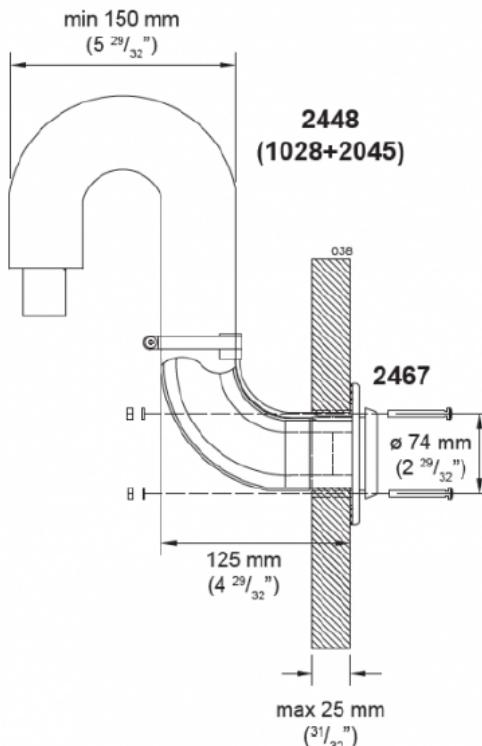
Avgasrörets utloppsrör **1028** bör vara 30-50 mm längre än förbränningsluftens sugrör **2045**. Så försäkrar man att avgasernas utloppsrör hålls på plats i bordgenomföringen. Längden är beroende av rörets totala längd.
