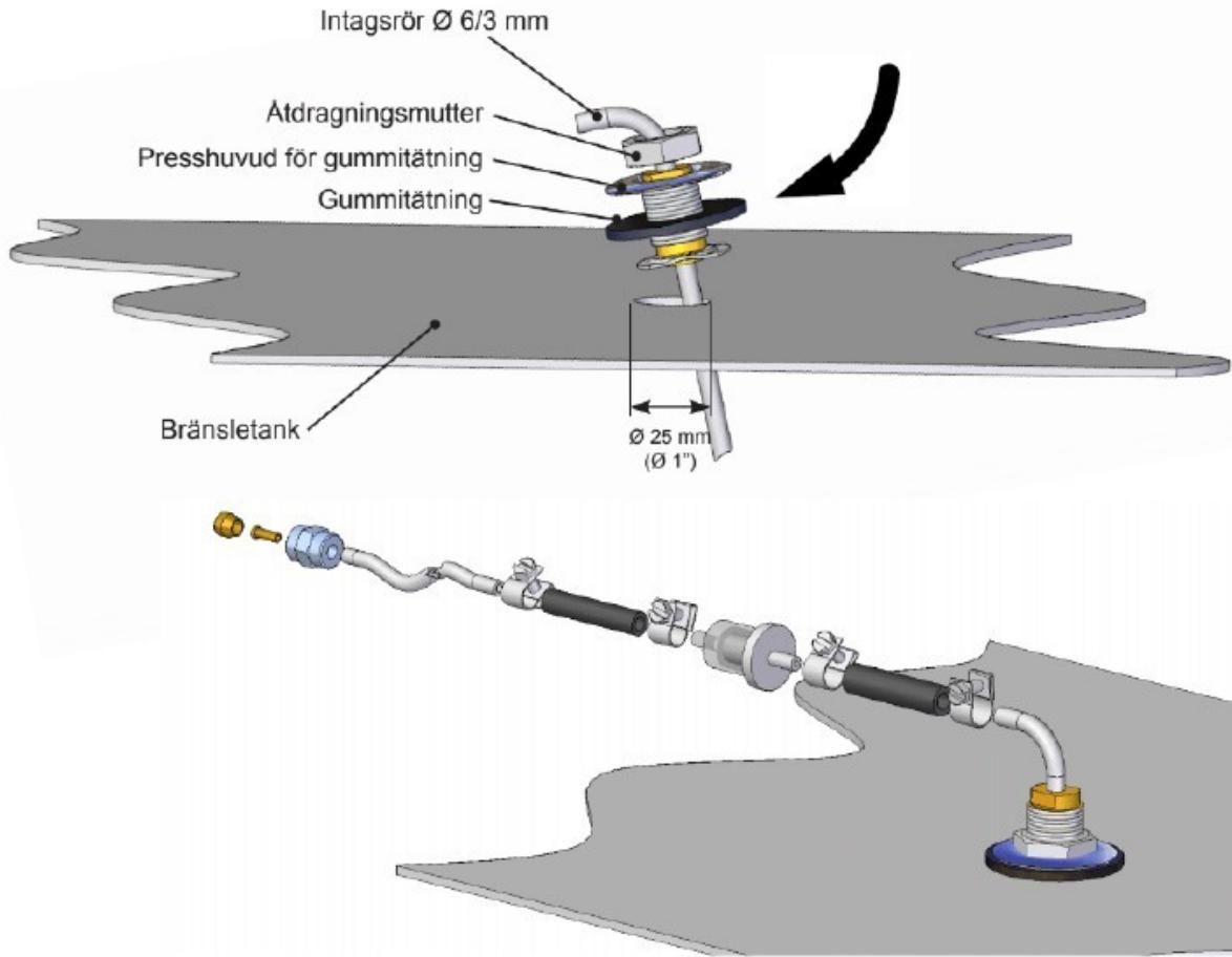
1. Först görs ett Ø 25 mm hål på toppen av bränsletanken. Välj hålets läge så att då bränsletanken lutar kommer inloppsrörets ända att hållas i bränslet även om tanken är inte full. Om inloppsrörets ända inte når bränslet, kommer enheten snabbt att avstängas av luften i bränslesystemet.
