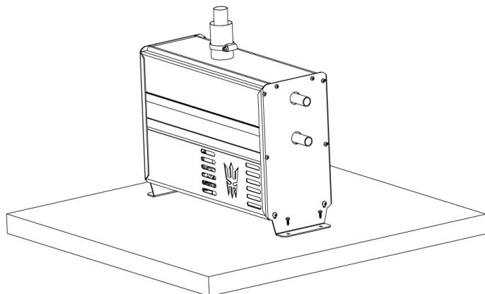
Lämmitin voidaan asentaa lattiaan "jalkojen" avulla. Kiinnitä laite tasaiselle vakaalle alustalle, joka ei ole kallistettu enempää kuin 5 astetta vaakatasosta. Vaikka laite ei välttämättä hajoa, jos se on tilapäisesti kallistettu jyrkästi (jopa muutaman tunnin ajan), polttimen suorituskyky ei ole optimaalinen, jos se on jatkuvasti kallistettuna. "Jalat" ja tarvittavat ruuvit löytyvät tarvikepussista
