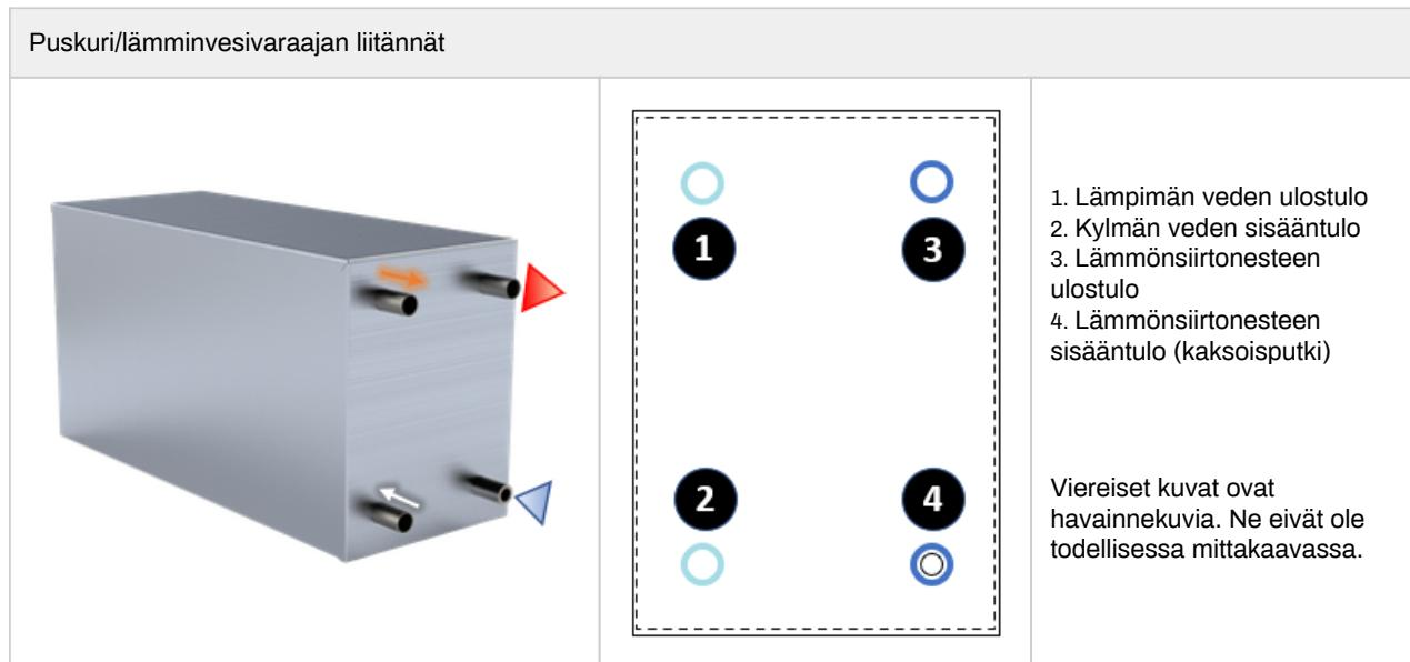
Makeavesijärjestelmään voidaan valita ja asentaa Wallas puskuri/lämminvesivaraaja. Noudata asennusohjeita oikean asennustavan varmistamiseksi.
