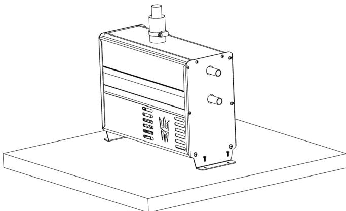
Värmaren kan installeras på golvet med hjälp av monteringsfötter. Fäst enheten på ett plant och stabilt underlag yta som inte lutar mer än 5 grader från det horisontella planeten. Medan enheten kanske inte går sönder om den tillfälligt lutas till en brant vinkel (även under några timmar), kan brännaren inte ge optimal prestanda om den är ständigt lutar. Monteringsfötter och nödvändiga skruvar finns i tillbehörspåsen.
