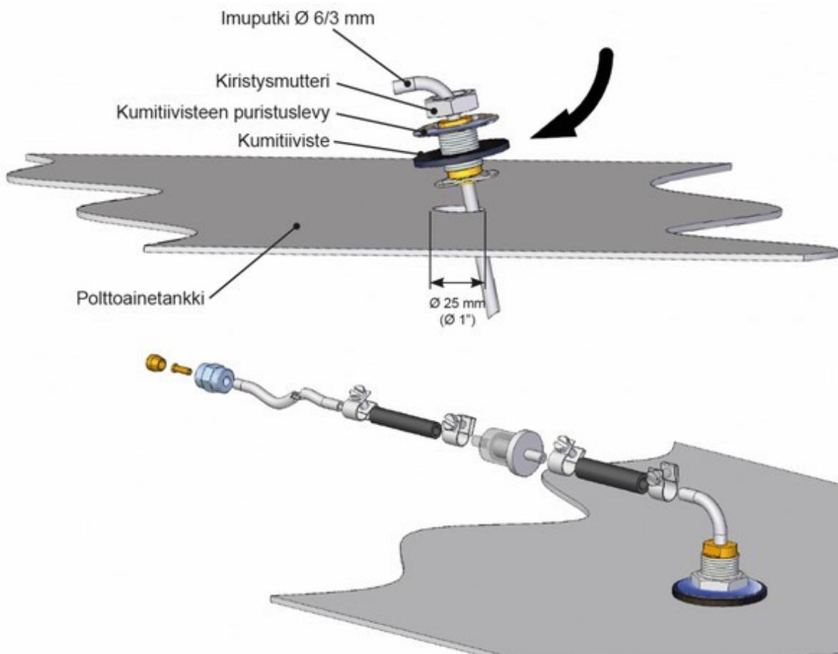
1. Polttoainetankin yläpintaan tehdään Ø 25 mm reikä. Valitse reiän paikka siten, että polttoainetankin kallistuessa polttoaineen imuputken pää jää polttoaineeseen vaikka polttoainesäiliö on vajaana. Mikäli imuputken pää ei ylety polttoaineeseen, laite sammuu hetken kuluttua polttoainejärjestelmässä olevaan ilmaan.
