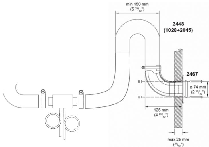
Vid behov kan ett dräneringslås installeras i avgasröret på ett skrov, men observera att dräneringslåset måste placeras efter svanhalsen.
