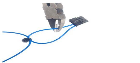
Paikallaan sininen "Enable" johtosilmukka, joka on kytketty lämmittimen pohjaan. Katkaise toinen johdoista liittimen läheltä ja liitä se pääkytkimeen +12V napaan.
