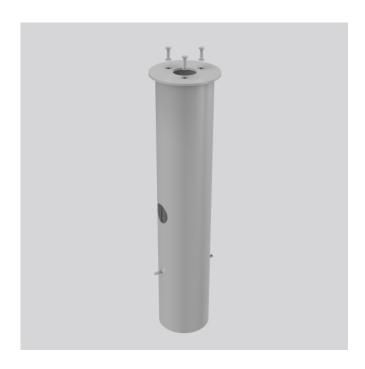
Eingrabstück für Pollerleuchten. Erdstück aus Aluminium mit Einsinkschutz und Befestigungs-Set. 3 Befestigungsschrauben M8 aus Edelstahl. Lochkreis Ø 100 mm. Nur geeignet für Lupalo und Bocaro Poller, nicht für Lichtstelen.
