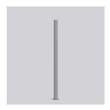
Standrohr mit Bodenplatte. Höhe 4200 mm . Standrohr aus Aluminiumprofil, seewasserbeständig pulverbeschichtet. Befestigungsplatte mit vier Anschraublöchern, seewasserbeständig pulverbeschichtet. Inklusive Befestigungsschrauben für Kabelübergangskasten. Masttür mit Dreikantschloss.
