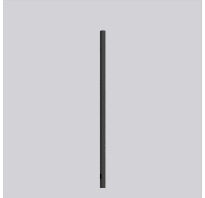
Standrohr mit Eingrabstück. Höhe 4200 mm . Standrohr aus Aluminiumprofil, seewasserbeständig pulverbeschichtet. Durchgehendes Erdstück mit zwei seitlichen Kabellöchern. Inklusive Befestigungsschrauben für Kabelübergangskasten. Masttür mit Dreikantschloss.
