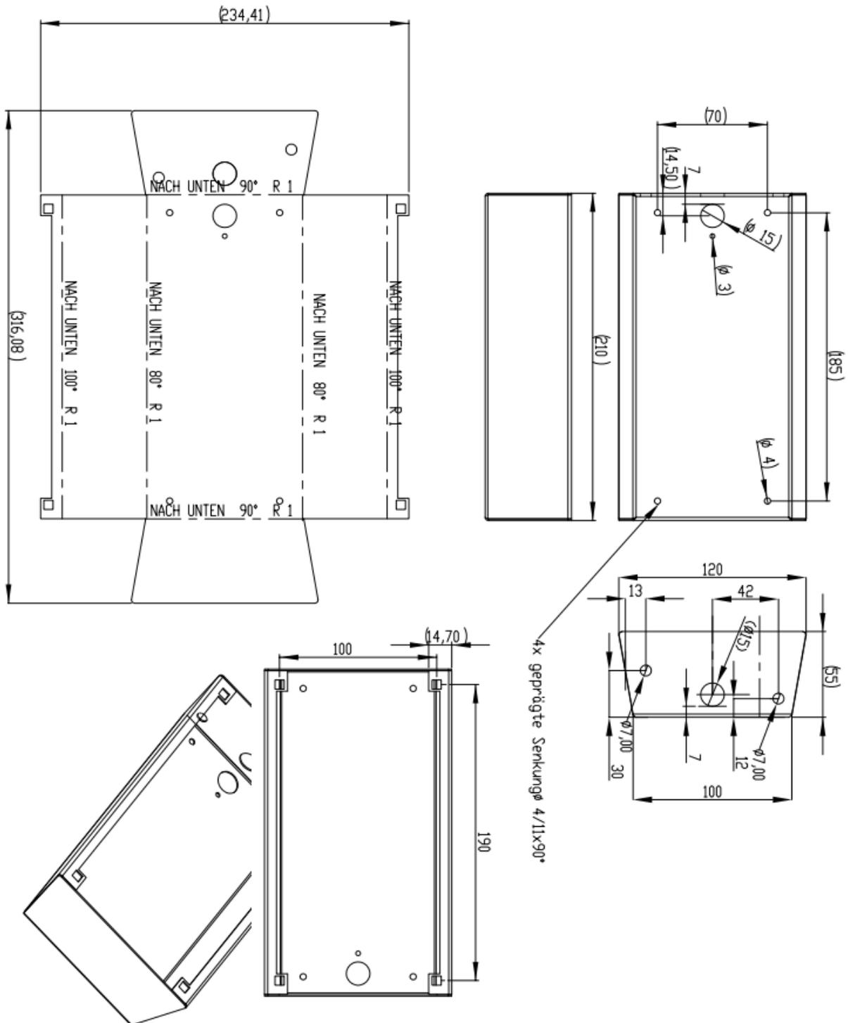
Die Montage der Video Türstation an oder in einer Mauer oder Zaunanlage setzt handwerkliche Kenntnisse und geeignetes Werkzeug voraus, z.B. Bohrmaschine, Bohrer, Dübel und ggfs. Abstandshalter. Diese sind im Lieferumfang nicht enthalten.
