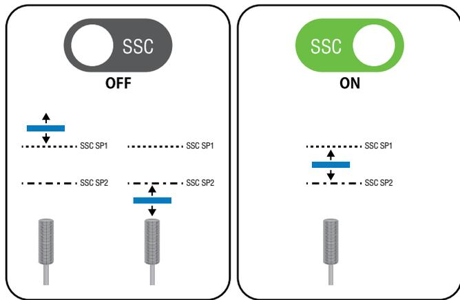
O modo janela permite que os projetistas monitorem uma faixa de valores, que pode ser definida por dois pontos de ajuste de comutação discretos. Como mostra o exemplo, a lógica padrão define o sinal de comutação para “alto” (SSC ON) se o valor medido estiver entre os dois pontos de ajuste. Em todos os outros casos, uma vez que o valor medido se move para fora da faixa definida, o sinal de comutação é definido como “baixo”.
