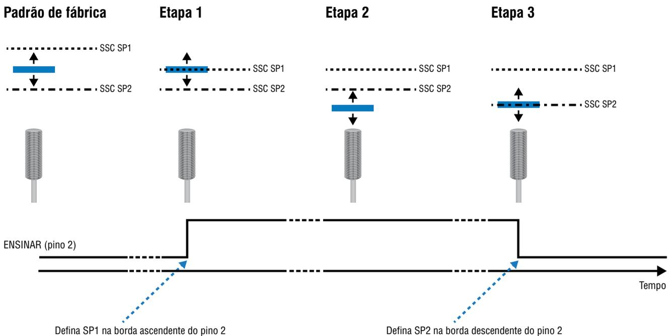
Posicionar o alvo no primeiro ponto de ajuste e disparar o pulso de instrução define SP1 na borda de subida do pulso. Reposicionando o alvo para o segundo ponto de ajuste e removendo o pulso de instrução, então define o SP2 na borda descendente do pulso.
