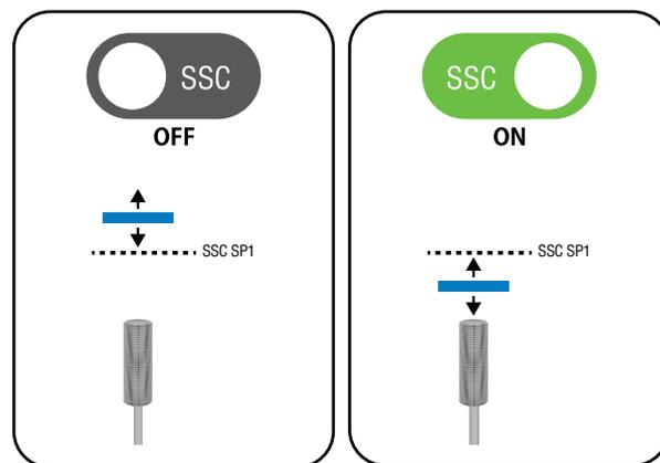
Com o modo de ponto único selecionado, os Sensores Inteligentes se comportam como dispositivos convencionais de dois estados. A lógica padrão (que pode ser invertida se a aplicação exigir) define o sinal de comutação para “alto” (SSC ON), se um nível de limite ou ponto de ajuste (distância de detecção alvo, por exemplo) foi atingido. De qualquer lado do ponto de comutação, o sinal simplesmente muda entre “alto” e “baixo” de acordo.
