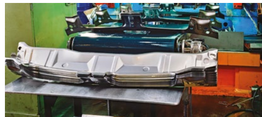
Vermeidung des Doppeleinzugs von Formteilen
