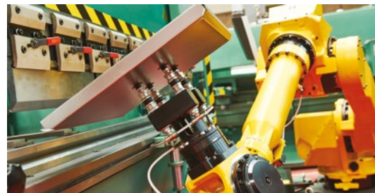
Vermeidung des Doppeleinzugs von Formteilen
