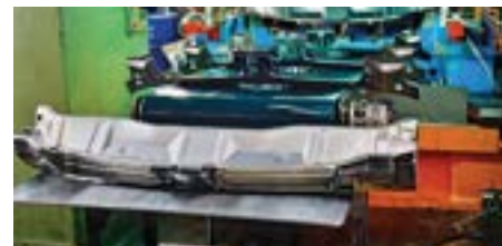
Restrição de dupla alimentação para peças moldadas
