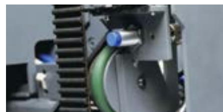
Monitoramento da tensão da correia de transmissão
