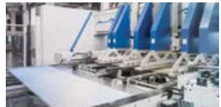
Controle de posição em fábrica de móveis
