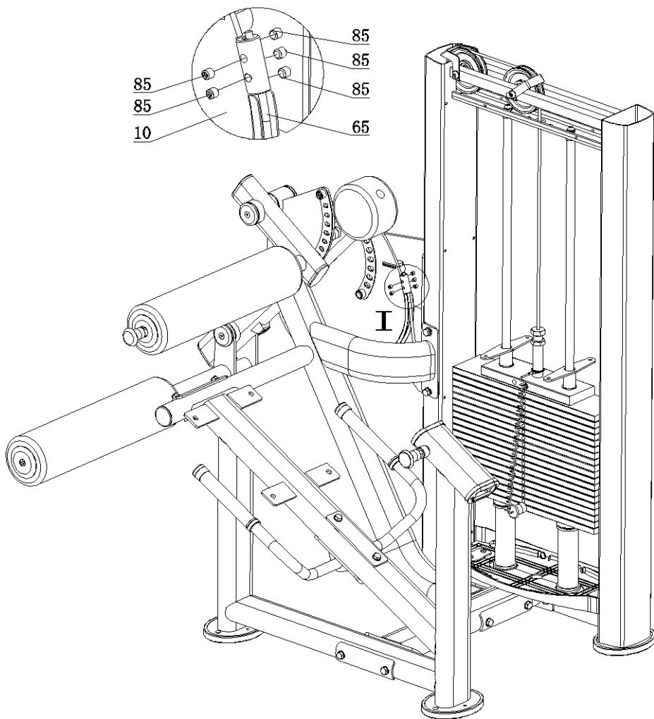
Fixe o cabo(65) no came(10) usando 5 parafusos allentrvantes(85).
