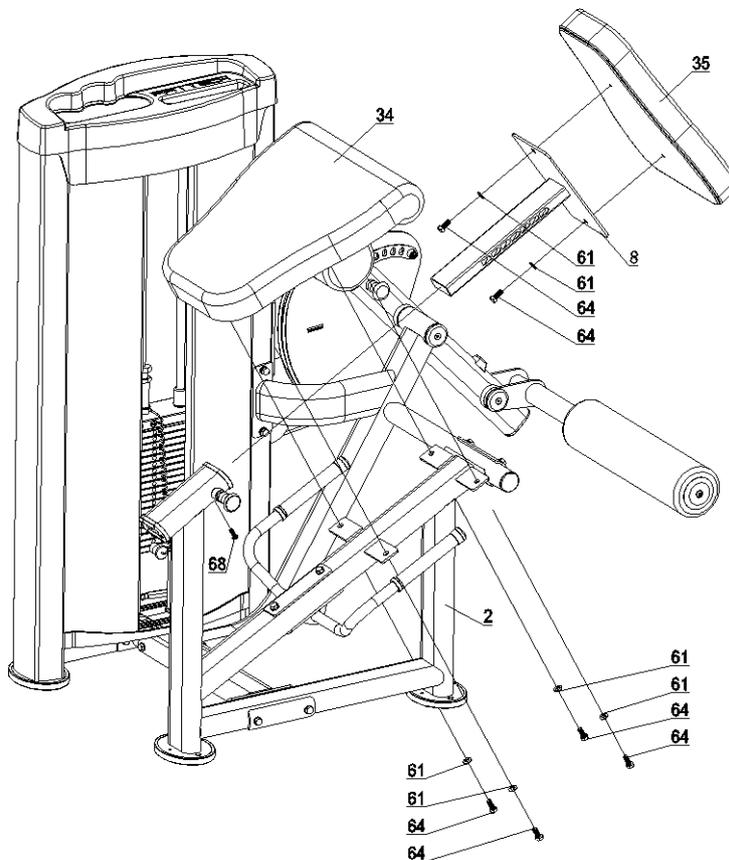
Fixe o estofamento(34) na estrutura principal(2), usando 4 parafusos Allen cabeça panela M10x25(64) e 4 arruelas lisas(61). Monte o encosto acolchoado(35) ao tubo de ajuste(8), usando 2 parafusos cabeça sextavada M10x25(64) e 2 arruelas lisas(61) e usando as chaves corretas para apertar os parafusos adequadamente.
