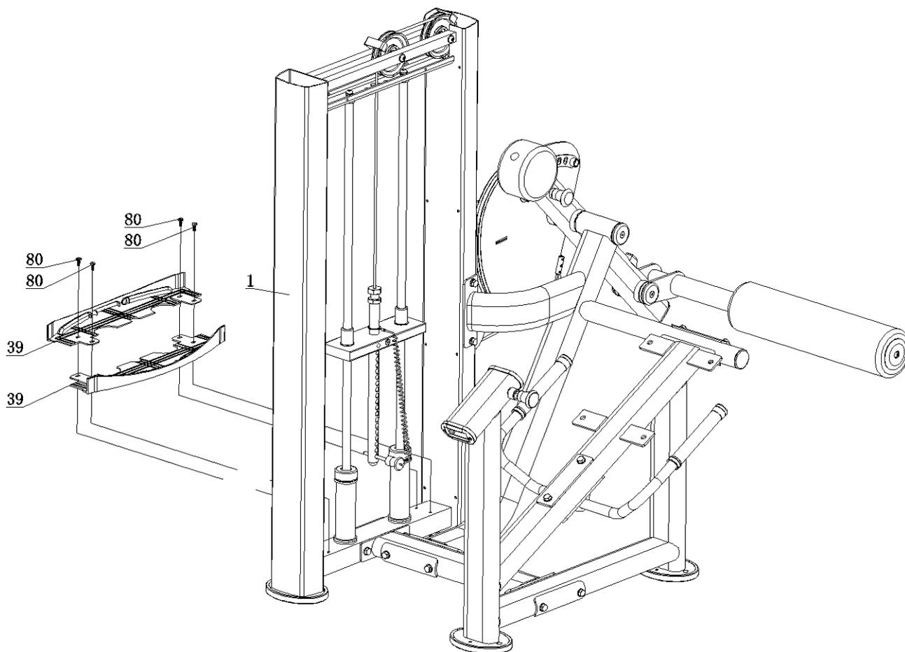
Fixe 2 carenagens inferiores(39) a torre(1) usando 4 parafusos Allen cabeça panela M6x15(80) e usando as chaves corretas aperte os parafusos adequadamente.
