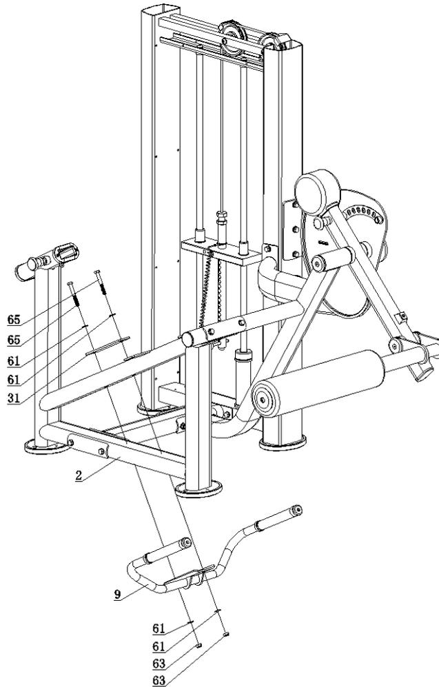
Monte o pegador(9) a estrutura principal(2), usando 2 parafusos cabeça sextavada M10x70(65), 4 arruelas lisas(61), 1 placa de fixação(31) e 2 porcas sextavadas auto travantesM10(63) e usando as chaves corretas aperte parafusos e porcas adequadamente.
