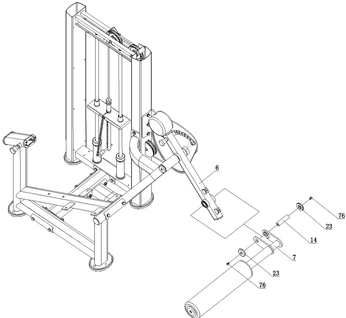
Montea estrutura do estofamento das pernas(7) ao braço de rotação(6) usando o eixo(14), 2 acabamentos de alumínio(23) e 2 parafusos Allen cabeça lisaM8x15(76).
