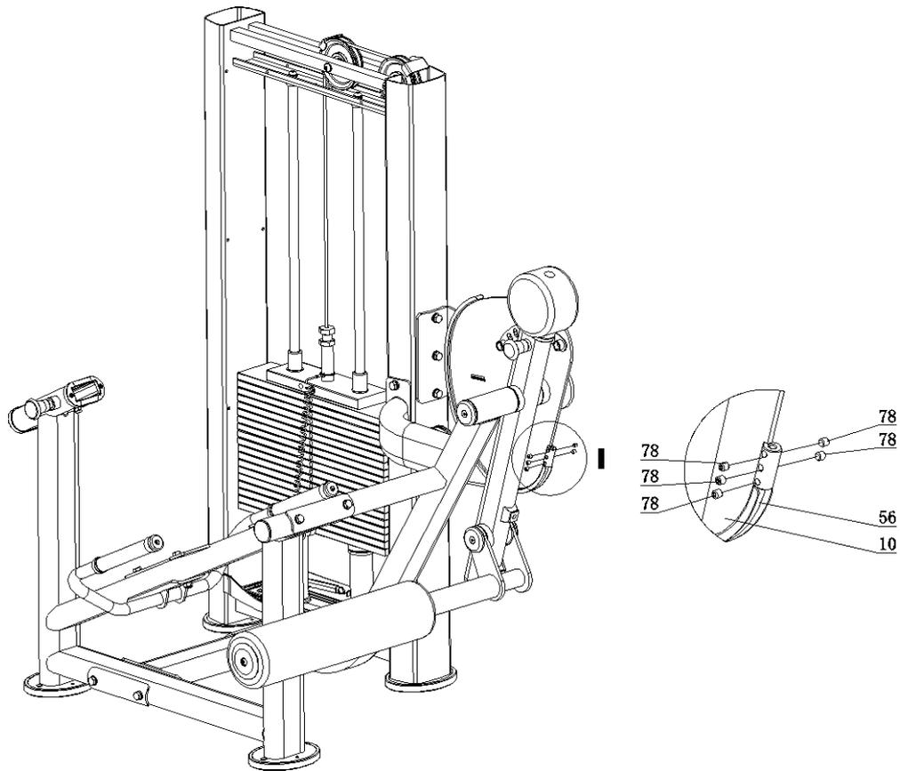
Fixe o cabo(56) no came(10) usando 5 parafusos Allen travantes M8x8(78).
