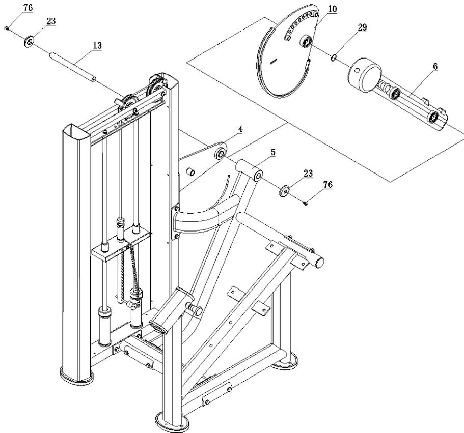
Monte o came(10), braço de movimento(6), estrutura de conexão(5), suporte do came(4), usando eixo(13), 1 arruela especial(29), 2 acabamentos de alumínio(23) e 2 parafusos Allen cabeça chata M8x15(76) e usando as chaves corretas aperte os parafusos e porcas adequadamente.
