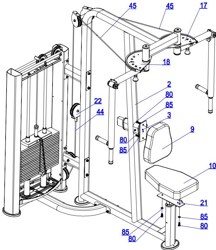
Fixe o cabo(44) no suporte da polia(22), insira o cabo(45)no suporte de polia(22) e suporte da polia presente na estrutura principal(2) e fixeno came esquerdo(17) e came direito(18). Monte o assento(10) e o estofamento de encosto(9) no quadro do assento(21)enaestrutura principal(2), usando4 parafusos cabeça sextavada M10x25(80) e 4 arruelas lisas(85) para fixar e usando as chaves corretas aperte os parafusos e porcas adequadamente.
