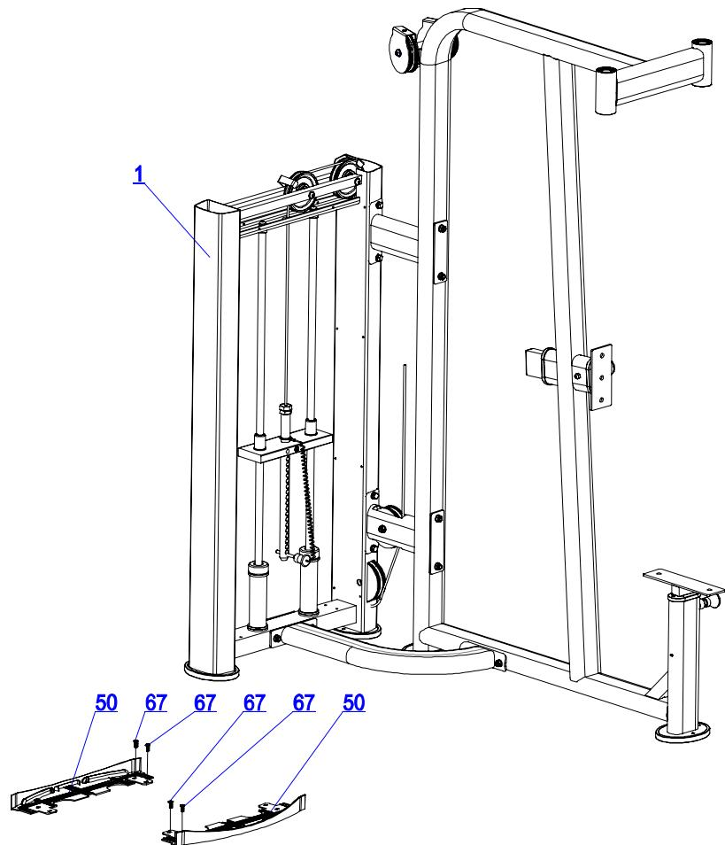
Fixe 2 carenagens inferiores(50) na torre(1) usando 4 parafusos Allen cabeça panela M6x15(67) e usando as chaves corretas aperte os parafusos adequadamente.
