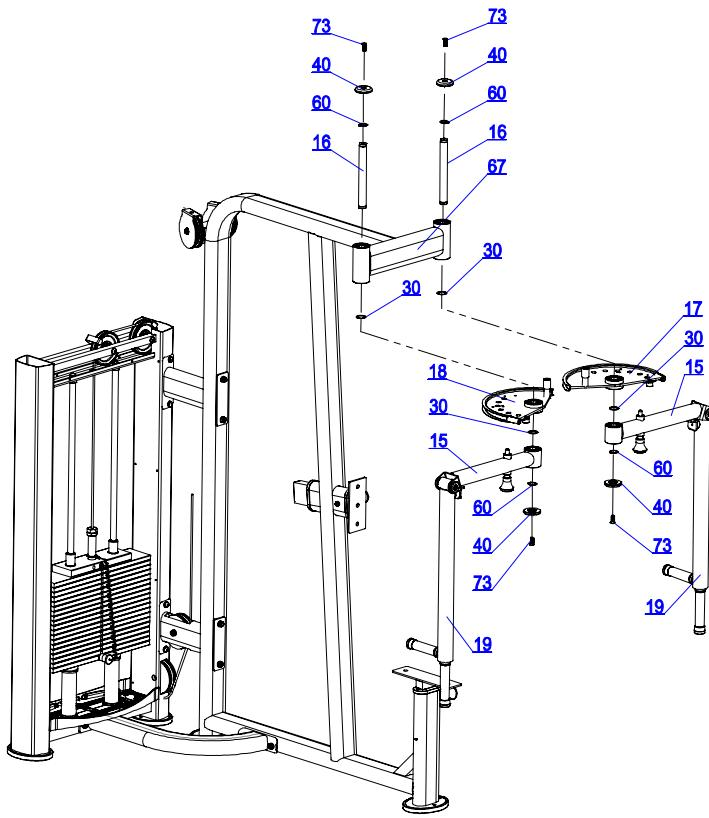
Insira 2 eixos(16) na estrutura principal(2). Insira nos 2 eixos(16),4 arruelas especiais(30), came direito(18), came esquerdo(17) e o conjunto braço direito e conjunto braço esquerdo, prestar atenção na posição do desenho(15 e 19), passo a passo usando 2 anéis elásticos(49), 4 acabamentos de alumínio(48) e 2 parafusos Allen cabeça panela M8x25(37). Usando as chaves corretas aperte os parafusos e porcas adequadamente.
