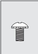
à mi-chemin dans le boîtier d'interrupteur supérieur. Pousser l'excédent de câble dans le boîtier d'interrupteur, placer les fentes en poire de l'ensemble d'éclairage autour des vis, puis tourner dans le sens antihoraire.
