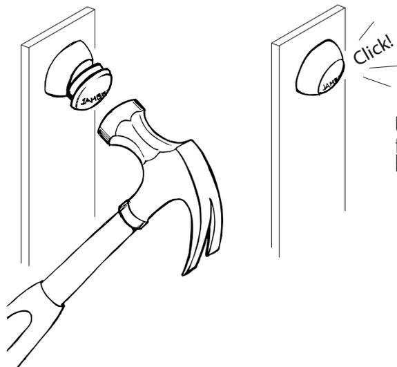
Une fois l'assemblage entièrement terminé, fermez les capsules en frappant sur les bouchons avec un marteau.
