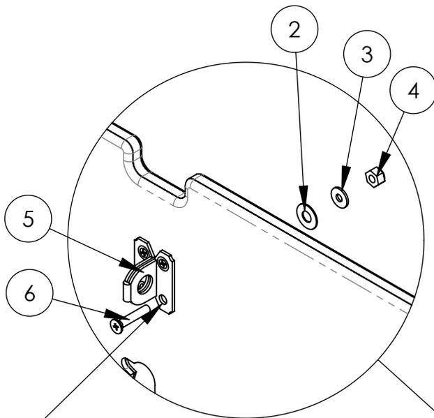
—Si vous désirez installer les morillons, complétez, à l'aide d'une mèche 1/4" de diamètre, le défonçage des trous pilotes situés sur la face intérieure du panneau
