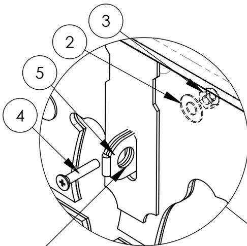
—Si vous désirez installer les morillons, complétez, à l'aide d'une mèche 1/4" de diamètre, le défonçage des trous pilotes situés sur la face intérieure du panneau
