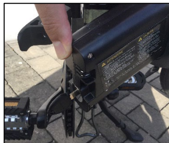
Figura 14 – Batteria parzialmente estratta.
