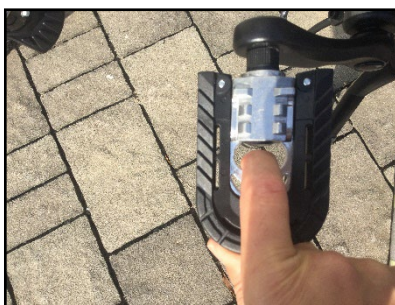
Figura 5 - Asola per sbloccare il pedale, tirando la linguetta.
