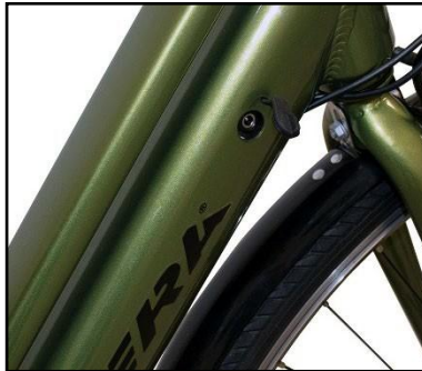
Figura 7 – Presa carica batteria sulla bicicletta.
